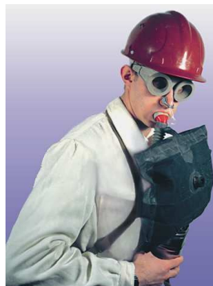
Рис. 43. Шахтный самоспасатель ШСС-Т:
