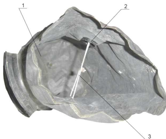
Рис. 32. Дыхательный мешок с клапаном натяжного действия: 1 – дыхательный мешок; 2 – клапан натяжного действия; 3 – нить
