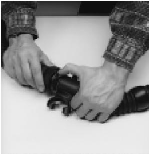
ze an beiden Anschlußstücken der Atemschläuche sorgfältig reinigen, Dichtfläche und O-Ring-Sitze leicht mit **Molykote 111** einfetten.
