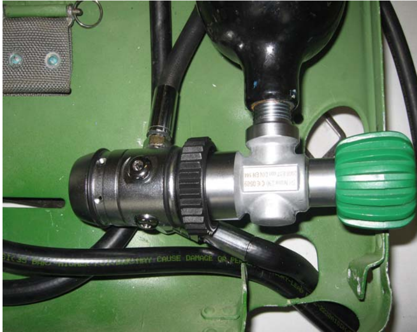
Nautec Ventil Kleinkonisch zur Nutzung vorhandener Sauerstoff Flasche Druckminderer Sauerstoff ( Mitteldruck fest bei 9 bar ) Der Durchbruch im Gehäuse muss vergrößert werden um das Ventil von außen zu bedienen
