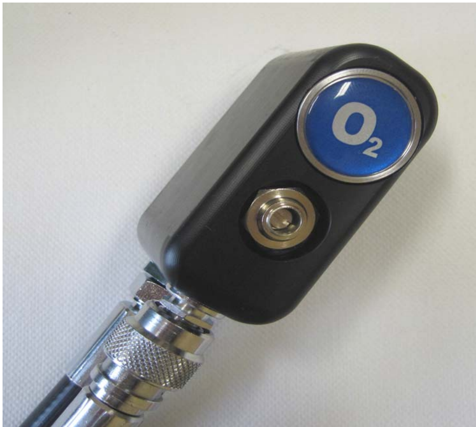
Sauerstoffbooster Enthält einstellbares Nadelventil und Booster zur manuellen Nachdosierung von Sauerstoff.
