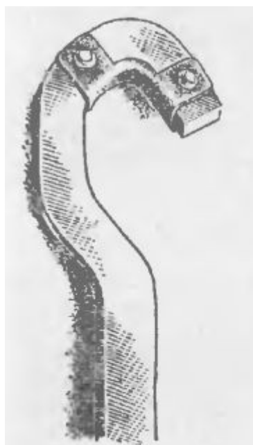
Рис. 30. Подвесной титановый крюк анодной корзины с приклепанной медной или никелевой накладкой для улучшения электрического контакта с арматурной штангой
