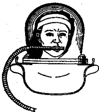
Рис. 21. Шлем вентилируемого снаряжения с приспособлением для выдоха в воду
