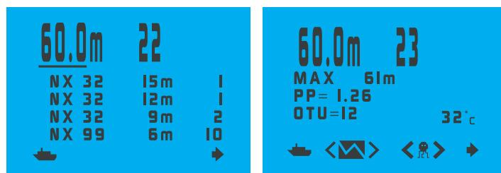
Выбирая на декомпрессионном DEC экране, Вы сможете пролистать с помощью несколько страниц, на которых записаны декомпрессионные остановки. На последней странице высвечивается последняя декомпрессионная остановка, текущие значения PO2, температуры и OTU (Oxygen toxicity unit, токсические единицы кислорода). Текущая глубина и время также высвечиваются вверху экрана. Пример обычного декомпрессионного экрана показан вверху.
